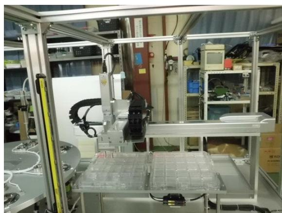
ワーク取出し部の電動アクチュエーター
