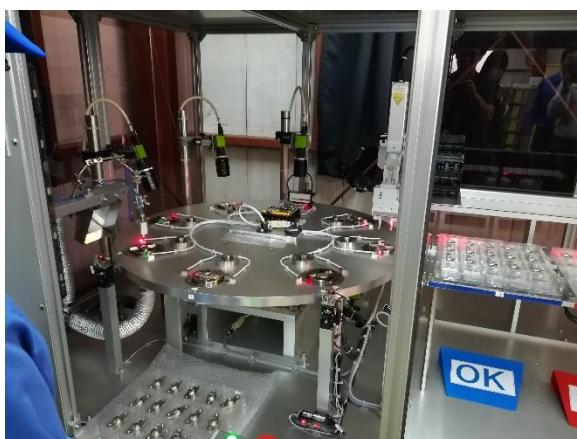
検査ワークをインデックステーブルにセット後、テーブルを回転させながら、4カ所のステーションでカメラによる検査
