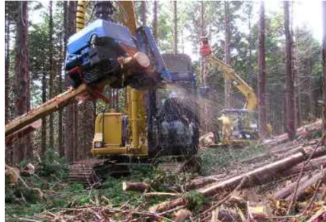
高性能林業機械による造材作業
