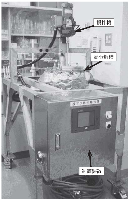
写真2 廃棄プラスチックの熱分解槽
