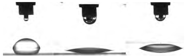
図6 PENシートの接触角測定時の液滴の様子 (左) 処理前 (中央) 酸素10秒処理 直後 (右) 酸素10秒処理 3時間放置後
