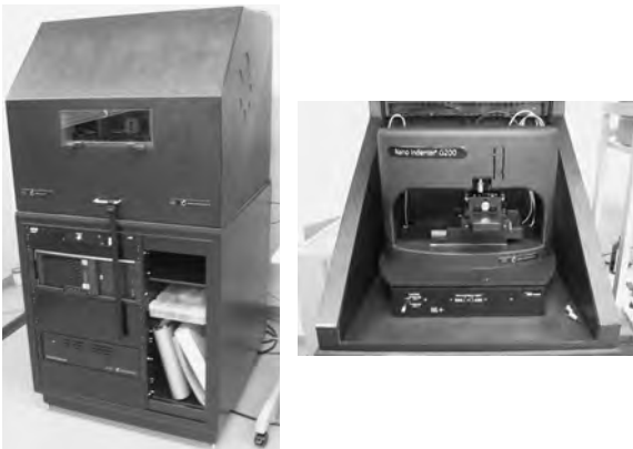
図5 微小押し込み硬さ試験機(左：外観 右：測定部)
