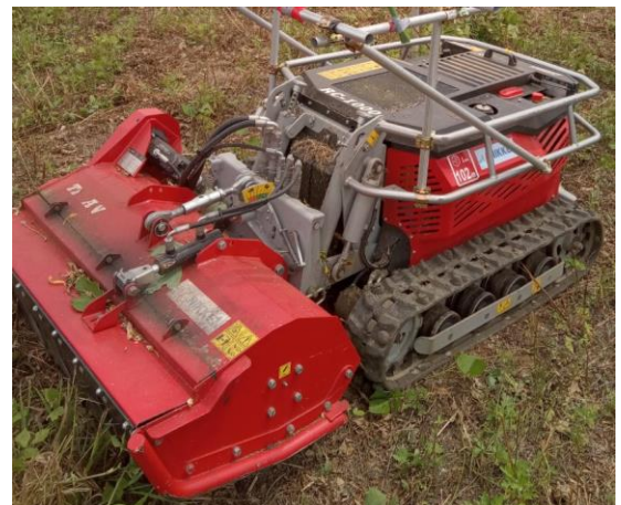
写真3 ラジコン草刈機の例（ハンマー方式）
