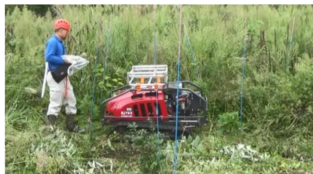
写真4 作業員 A とラジコン草刈機(ロータリー方式)
