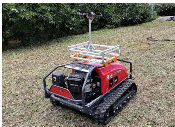
遠隔操作試験中のカメラを搭載した自走式草刈機
