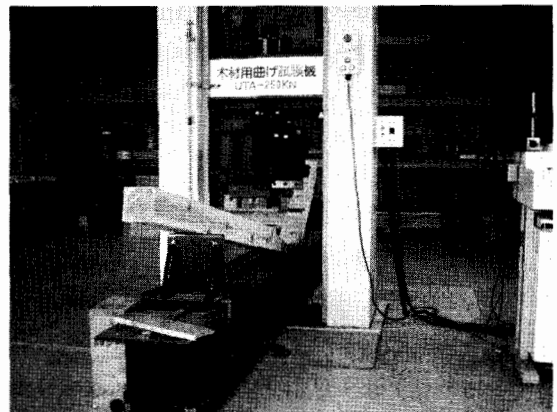
Fig. 5 曲げ強さの測定風景
