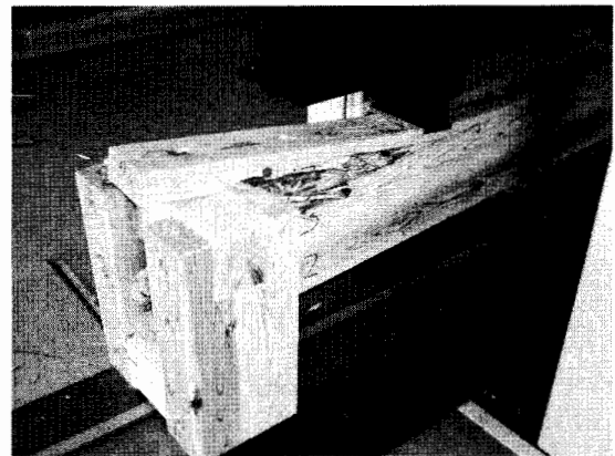
Fig. 24 進入防止柵の柱と横架材の接合付近の強度試験風景
