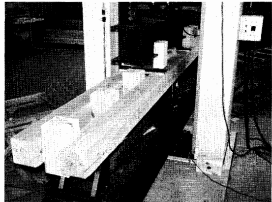
Fig. 18 藤棚梁部分の強度試験風景 (1)
