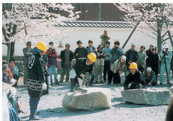
大勢の人々がじっと見つめていますね(石割実演) はりまわしで矢を大きく叩きこむ石工さん
