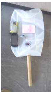
図1 投下回収型雪崩検知装置
