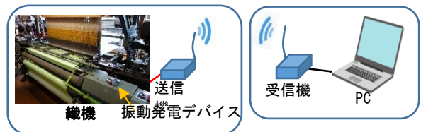
図3 織機の見守り通信システムの概略図
