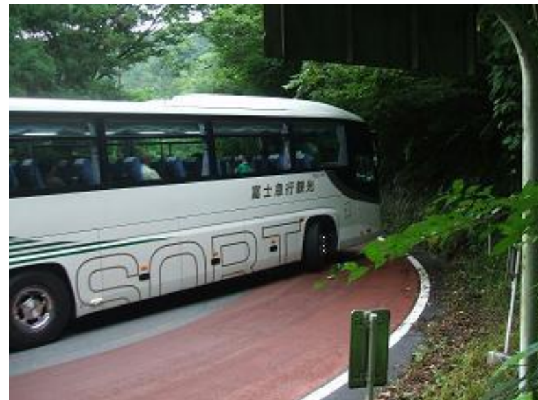
② カーブ半径の不足 反対車線にはみ出す大型車
