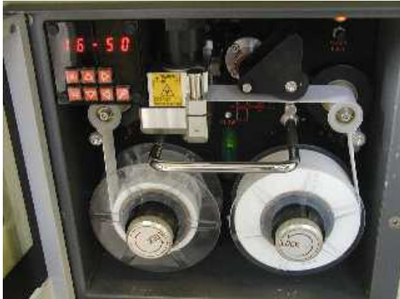
図1 SPM自動測定機 (1時間に約1m 3 の大気をろ過し、ろ紙上のSPMを計る)
