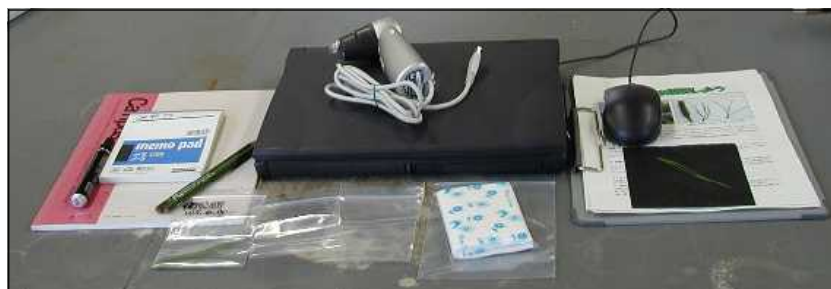
ノートとメモ帳、鉛筆、油性ペン、チャックつきポリ袋、ティッシュペーパー パソコン、カラー・プリンター、デジタルカメラ USB実体顕微鏡(マイクロスコープ：SCALAR社製ベーシックセット 29,800円) レンズ(100倍：SCALAR社製 M100 15,000円)
