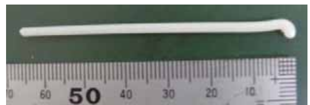
図3 3点曲げ試験を行った棒状樹脂
