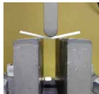
図4 棒状樹脂の3点曲げ試験の様子
