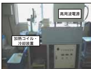
試作した熱処理装置
