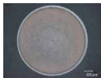
直径3mmの棒鋼に対する熱処理結果
