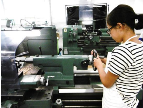
【金属に直径22mm, 深さ50mmの穴の加工】
