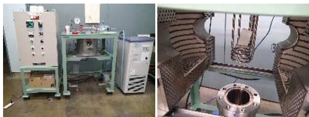
図1 オートクレーブ (左: 外観 右: 圧力容器内部)
