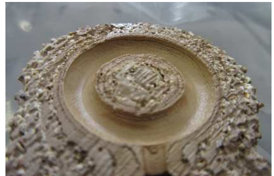
図4 切断後の断面（上部から横部に亀裂あり） （脱ろう温度：300℃）
