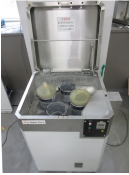
図2 遠心バレル研磨機
