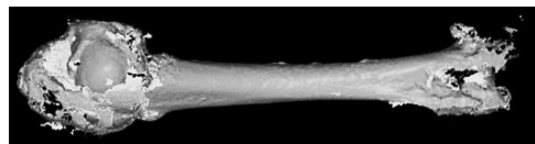
(b) 3D スキャナを用いた骨の外表面の取得像
