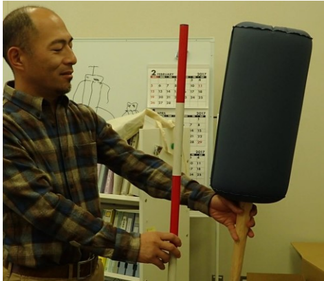
図1 投下回収型雪崩観測装置の外観
