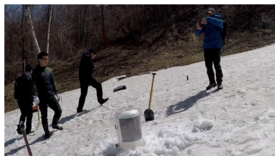
図5 IoT観測装置 (雪崩観測) の設置例
