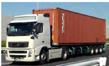
国際海上コンテナ車(40ft 背高) 写真：国土交通省 道路局 「重要物流道路制度における国際海上コンテナ車の運用について」
